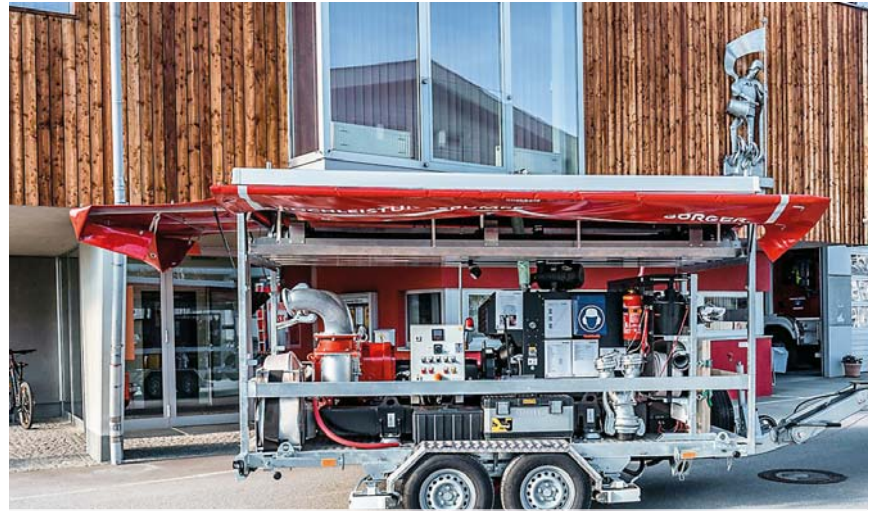
Bürger Hochleistungspumpe FF Kirchberg - maximale Förderleistung von 5.800 l/min. Bestens geeignet um, im Katastrophenfall auch überflutete Großbereiche auspumpen zu können.
