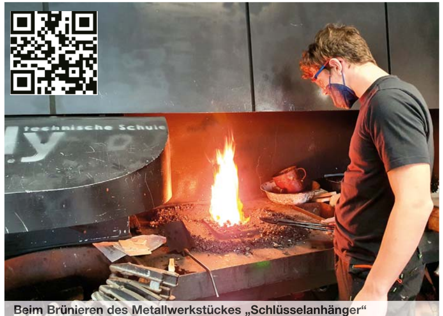
Beim Brünieren des Metallwerkstückes „Schlüsselanhänger“
